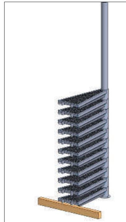
Bestimmen Sie den Befestigungspunkt des Zentralstandrohres und richten Sie das Rohr über diesem Punkt auf.
