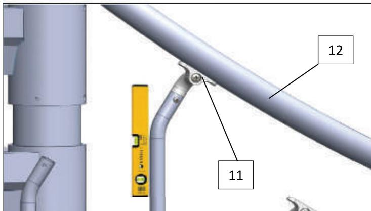
Haben Sie die Rohrsegmente auf den hinteren Geländerstäben angebracht, richten Sie die Geländerstäbe lotrecht aus und verbinden den Handlaufhalter (11) mit dem Handlaufrohr (12) mittels der Senkkopf-Schraube (19). Nutzen Sie hierfür den beiliegenden 4mm Spiralbohrer (27) zum Vorbohren.
