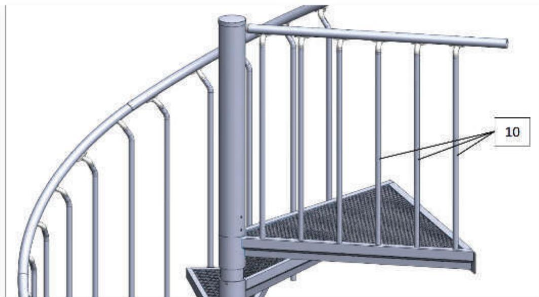
Kontrollieren Sie bitte abschließend sämtliche Schraubverbindungen an dieser Treppe und ziehen gegebenenfalls die Verbindungsmittel nach.
